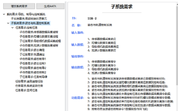
Fig.6 Requirement template of AOCSS subsystem in Req. Modeling plugin 图6 Req. Modeling plugin 中的 AOCSS 子系统需求模板
